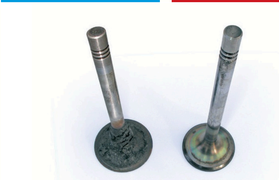
Soupape   100 000 km, avant le test
