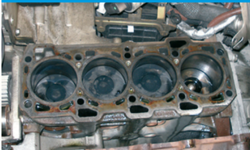
Bloc moteur   100 000 km, avant le test
