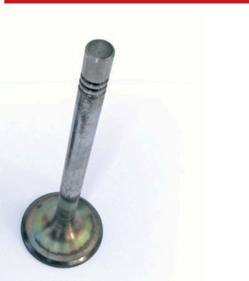
Soupape   150 000 km,   la fin du test et apr s traitement avec Exel Motor.
